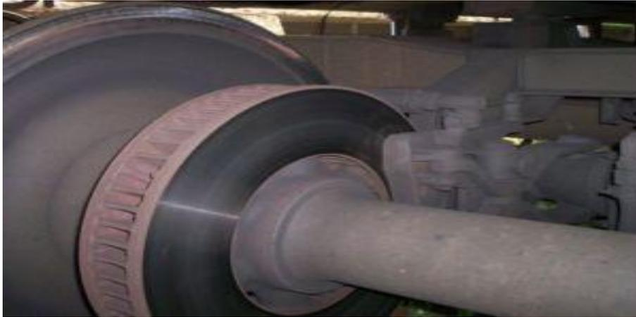
Fig. 11 Disc Brake
